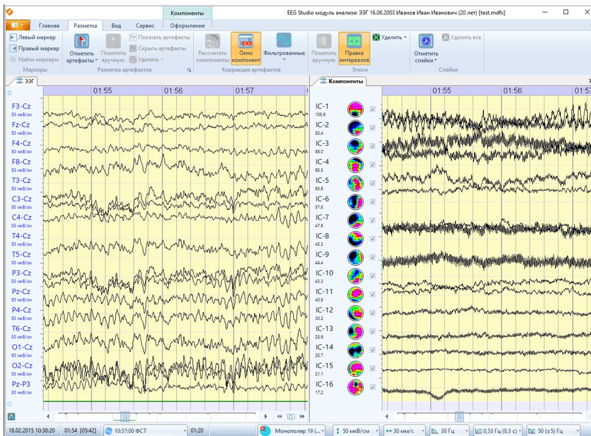
Рядом с цветовыми картами по умолчанию проставлены «галочки». Снятие «галочки» напротив компоненты удаляет данную компоненту из всех отведений. Компоненты в списке расположены в порядке убывания своего воздействия на сигналы.
