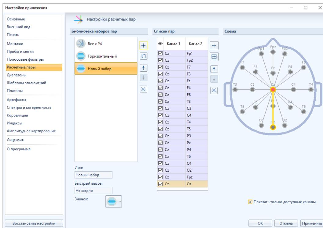
При выборе в списке пар какой-либо пары (или при добавлении), в поле «Схема» данная пара будет подсвечена отрезком желтого цвета. Любые изменения в таблице «Список пар» будут соответственно отражаться в «Схеме». В таблице можно выделить любое количество строк, используя клавиши [Ctrl] и [Shift].
