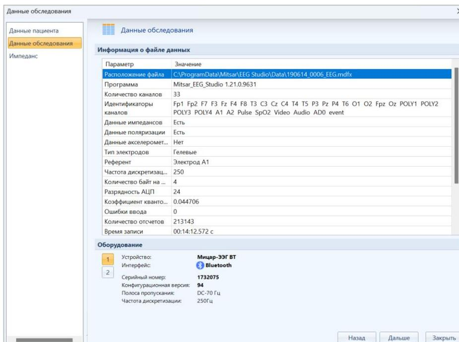
Если при записи обследования использовался пульсоксиметр, то в разделе оборудование появятся 2 кнопки 1 2, при нажатии на первую будет отображаться
