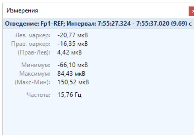
Окно «Измерения» содержит значения сигналов для левого и правого маркеров, разницу значений правого и левого маркеров, максимальное и минимальное значения сигнала на выделенном участке, амплитуду сигнала и частоту.
