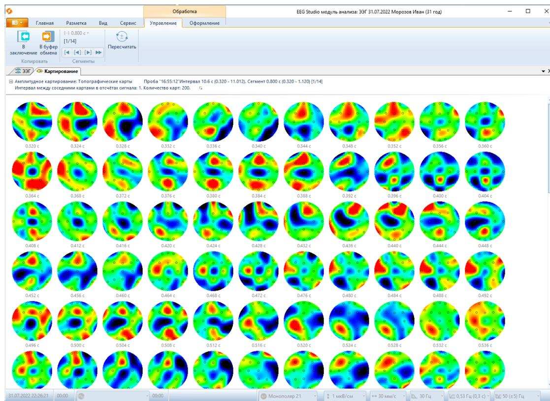
На вкладке «Картирование» изображены амплитудные карты, причем временное расстояние между картами составляет 0,002 секунды для обследований с частотой дискретизации – 500 Гц (0,004 секунды для обследований с частотой дискретизации – 250Гц), число карт на вкладке, по умолчанию равно 200.
