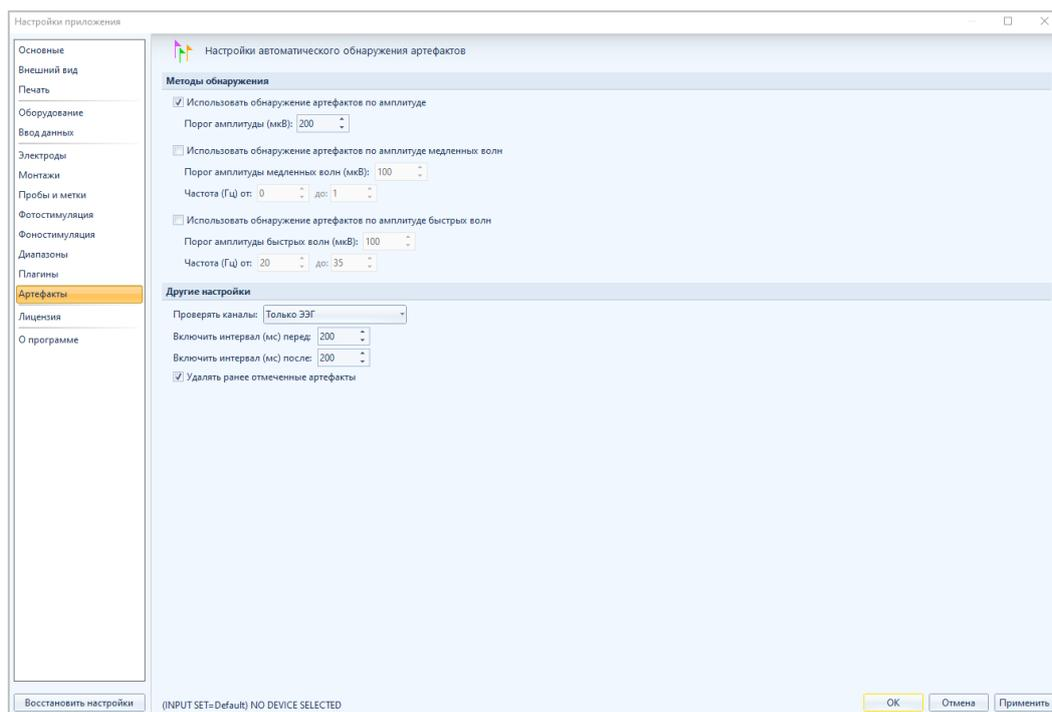
Для выбора метода, которым будет происходить поиск артефактов, поставьте или снимите галочку напротив нужного метода. Изменить порог амплитуды и для двух последних изменить частоту можно, либо нажимая стрелочки «вверх\вниз» в нужном окошке, либо введя значения вручную с клавиатуры, поставив курсор в нужное окошко. Максимальный порог амплитуды – 10000 мкВ, минимальный – 0 мкВ. Максимальное значение частоты – 100 Гц, минимальное – 0 Гц.
